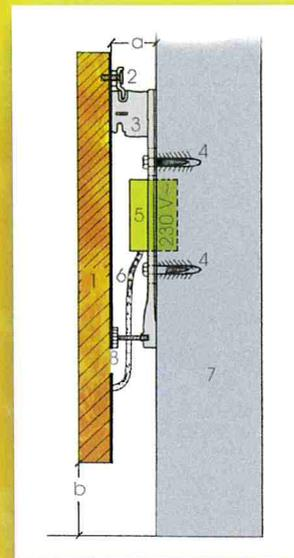
Die Montage der Natursteinheizung ist kinderleicht! Einfach Halterungen anbringen, Platten einhängen und Thermostat anschließen.
